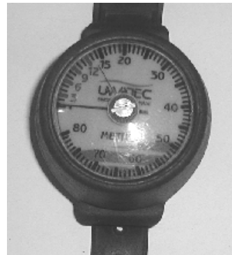
Dosentiefenmesser (ölgefüllt), Anzeige bis 80m
